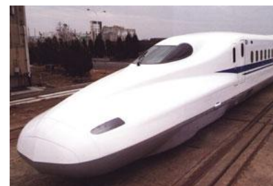
Опытный электропоезд 994. Головной вагон с обтекаемой носовой частью
