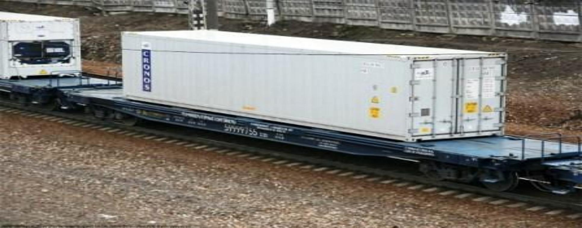
**Платформа** — грузовой вагон открытого типа, предназначенный для перевозки длинномерных, штучных грузов, контейнеров и оборудования, не требующих защиты от атмосферных воздействий.
