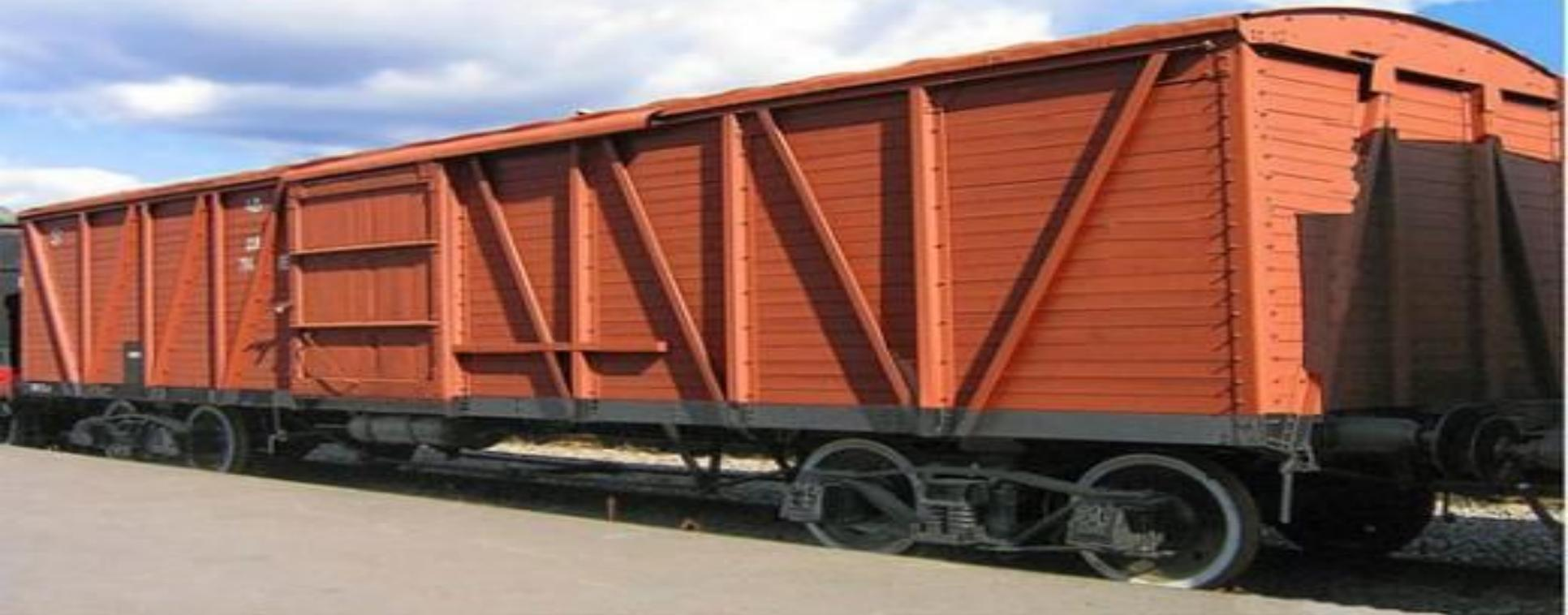
**Крытый железнодорожный вагон** - предназначенный для перевозки грузов, которым необходима защита от атмосферных осадков (снег дождь). Стандартный крытый грузовой вагон имеет по бокам раздвижные ворота для погрузки-выгрузки грузов. Опционально могут быть люки для освещения и отверстия для вентиляции.
