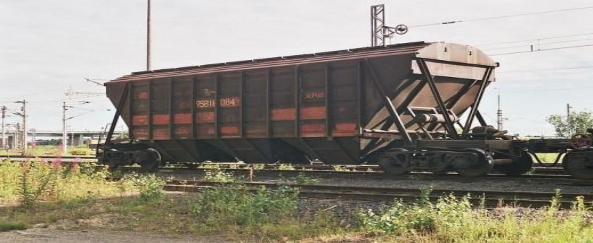
**Хоппер** — саморазгружающийся бункерный грузовой железнодорожный вагон для транспортировки и перевозки сыпучих грузов: угля, руды, цемента, зерна, балласта. Кузов хопера имеет форму воронки, в нижней части расположены люки, через которые груз высыпается при разгрузке. Существуют два типа хoppers — открытые и закрытые. Закрытые применяются для тех грузов, которым необходима защита от осадков. Открытые применяют для грузов, которые можно легко высушить без вредных последствий.
