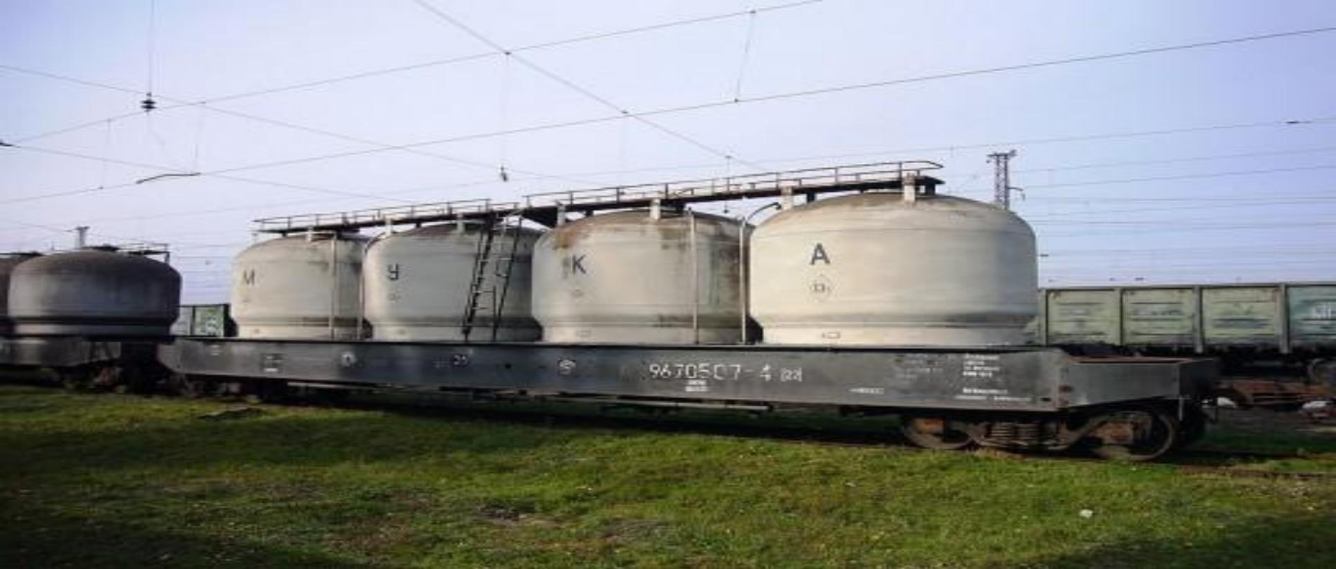
**Вагон бункерного типа** — крытый вагон для перевозки грузов (сыпучих: мука, зерно, щебень, неопасных нефтепродуктов: вязкий нефтебитум и нефтяной кокс), снабженный емкостью для груза и устройством, позволяющим загружать и разгружать груз без ориентирования — «навалом».
