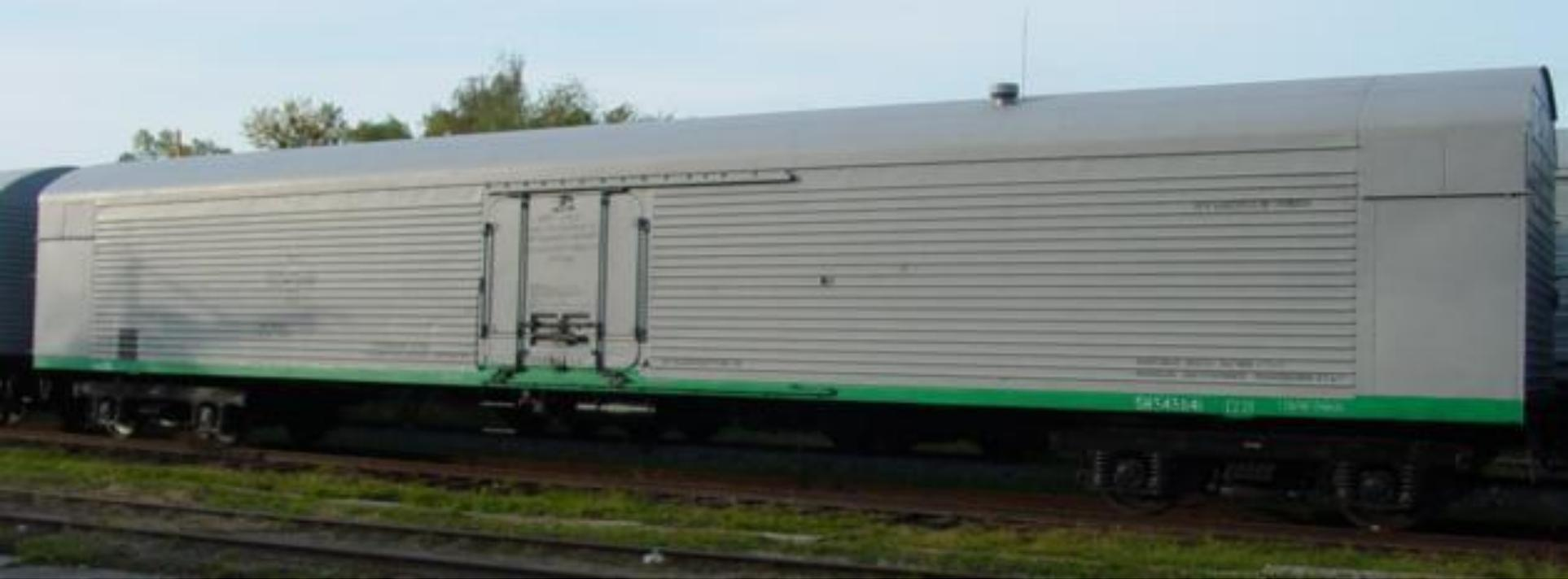
**Изотермический вагон** — крытый грузовой вагон для перевозки скоропортящихся грузов. Кузов изотермического вагона для уменьшения тепловых потерь снабжён теплоизоляцией из полистирола, пеноволиуретана и других материалов, имеет приспособления для рационального размещения груза. Для поддержания постоянной и равномерной температуры воздуха изотермический вагон может иметь приборы охлаждения и отопления, устройства для принудительной циркуляции воздуха и вентилирования грузового помещения.
