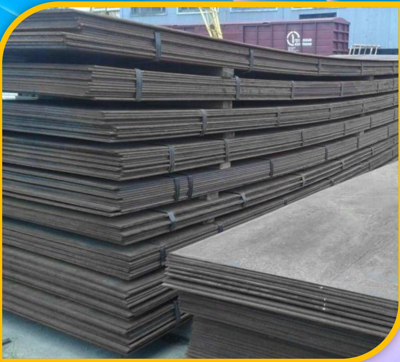
**Корпус бункера и опоры изготавливаются из листового проката стали 09Г2С (содержит 0,09% углерода, до 2% марганца, и менее 1% кремния), предназначенной для второстепенных и много нагруженных элементов сварных и не сварных конструкций.**
