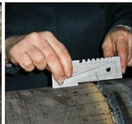
**Внешним осмотром невооруженным глазом или с помощью лупы выявляются, прежде всего, дефекты швов в виде трещин, подрезов, пор, свищей, прожогов, наплывов, непроваров в нижней части шва.**
