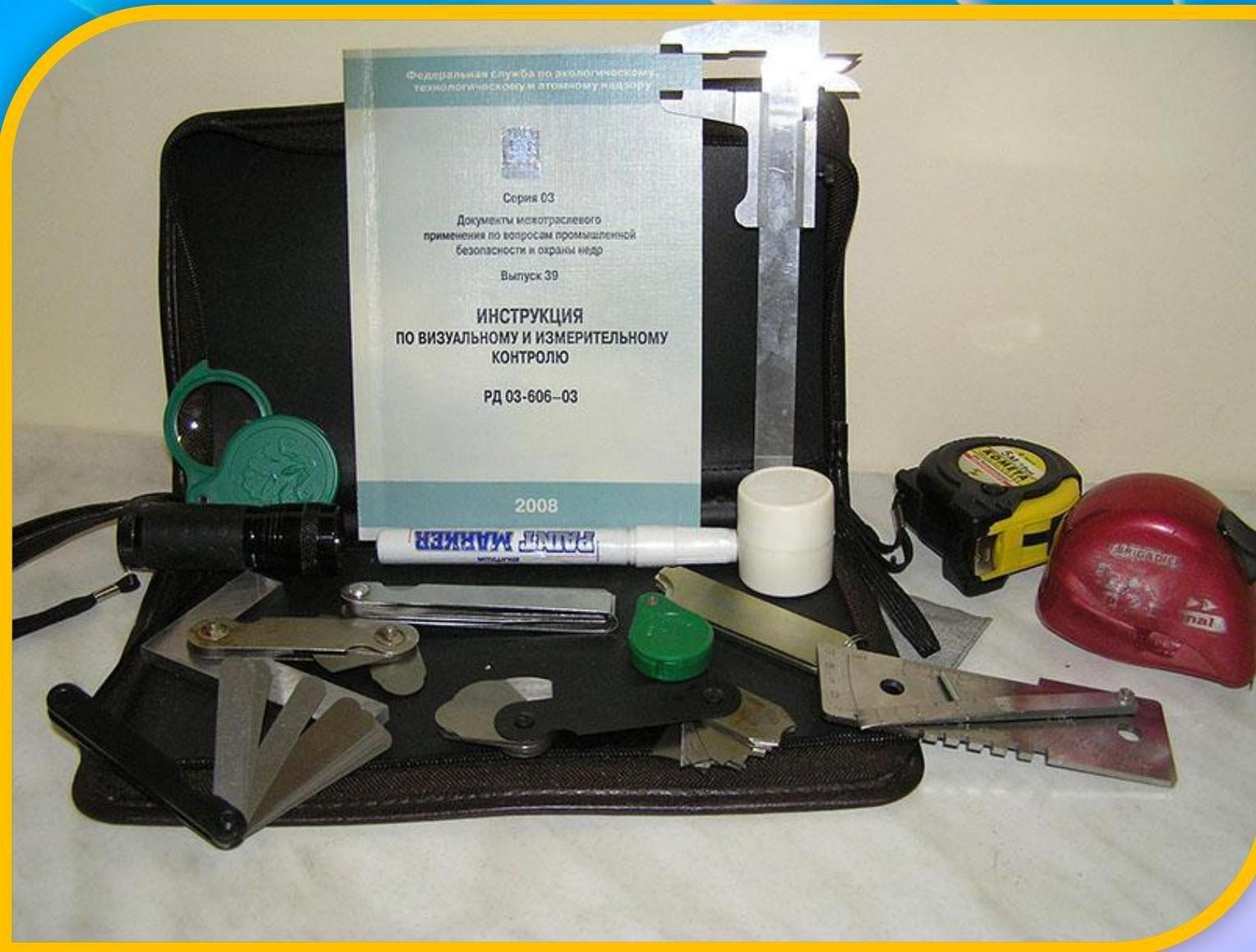
**Визуальный и измерительный контроль позволяет проверять качество подготовки и сборки заготовок перед проведением сварочных работ, качество выполнения швов в процессе сварки и качество готовых сварных соединений.**
