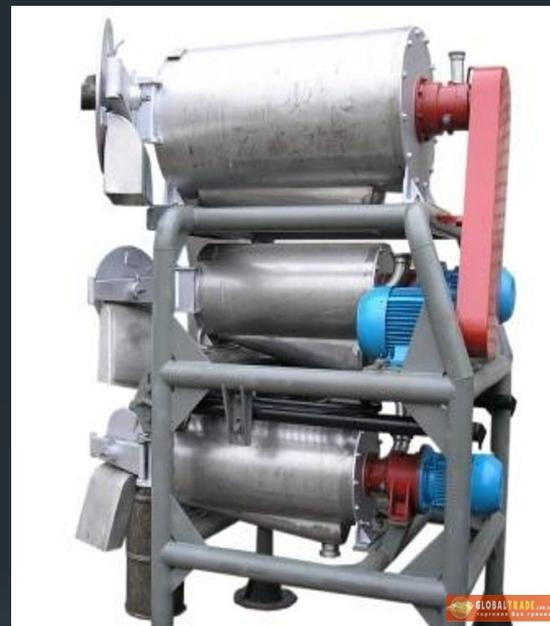
Трехступенчатые протирочные машины
