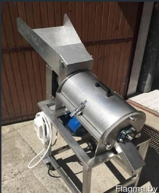
Одноступенчатые протирочные машины
