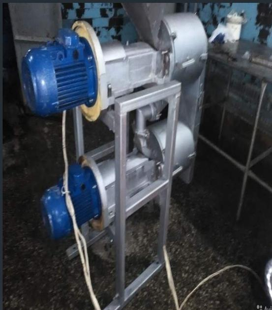
Двухступенчатые протирочные машины
