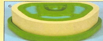
6 Форму для дублирования Мастер-копия до отверстий в стабилизаторе заполняют силиконом.
