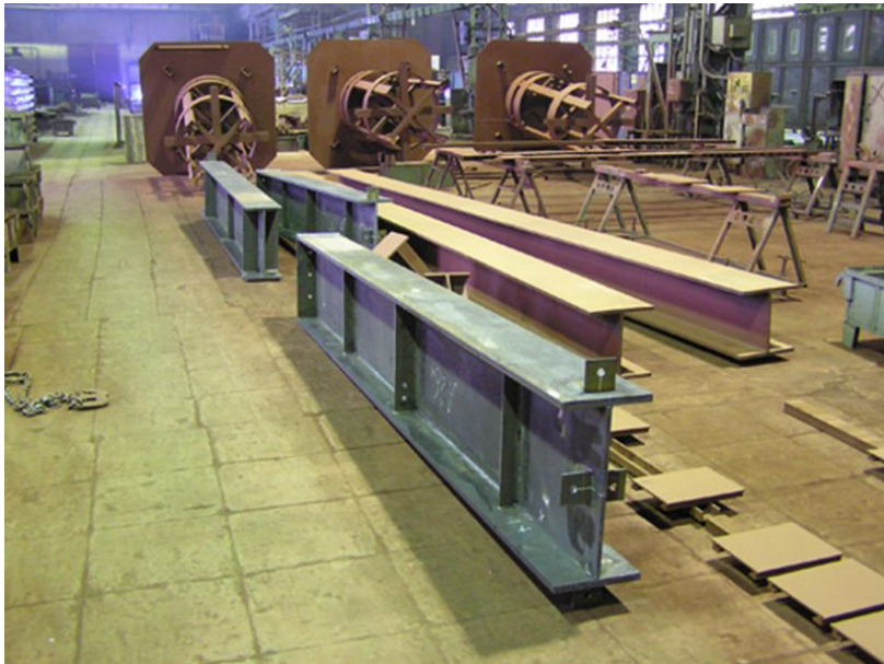
Балка двутаврового сечения
