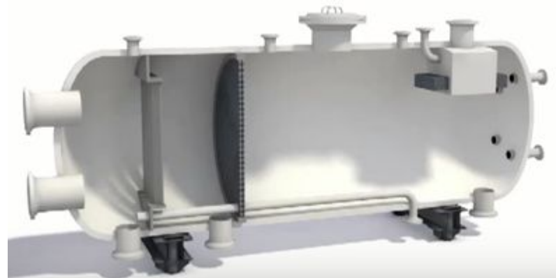
Схема горизонтального сепаратора 1 – технологічна ємність, 2 – похилі жолоби, 3 – лінійний засувку, 4 – вихід газу, 5 – регулюючий клапан, 6 – вихід нафти, 7 – пристрій для запобігання утворення воронки, 8 – люк-лаз, 9 – розподільний пристрій, 10 – введення продукції.
