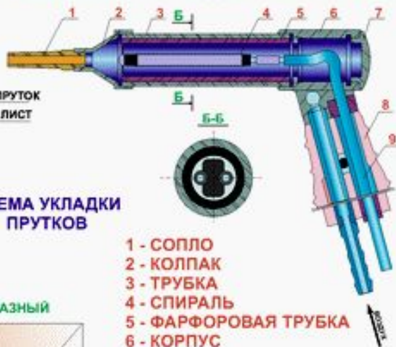
ГОРЕЛКА С ЭЛЕКТРОПОДОГРЕВОМ ГЭП-1А-67
