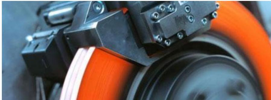
Если на педаль тормоз нажимать непрерывно, температура может подняться до 400-500 градусов. А вот это уже по-настоящему опасно! При перегреве дисков и колодок тормозная система почти полностью перестает работать.
