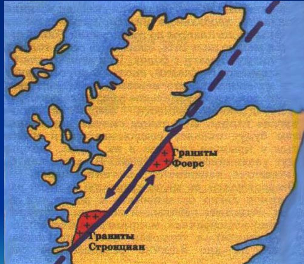
Разлом, относительно которого произошло смещение слоев, называется ***сместителем***.
