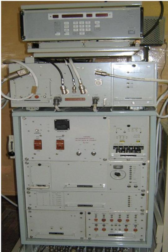
**1 Передатчик Артек-1 КВ всех исполнений представляет собой автоматизированное дистанционно управляемое радиопередающее устройство мощностью 1 кВт.**
