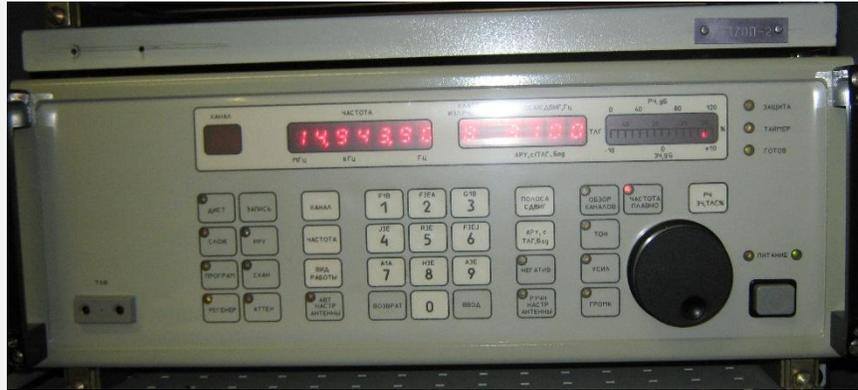
**РПУ предназначено для измерения уровня помех на всех фиксированных частотах, выделенных для связи в обоих каналах.**
