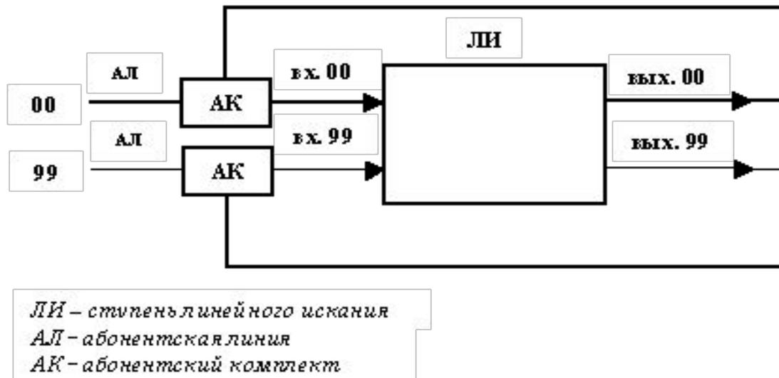
В данной системе каждая абонентская линия АЛ имеет индивидуальный коммутационный прибор – линейный искатель на 100 линий (прибор типа 1×100), который осуществляет выбор линии вызываемого абонента.
