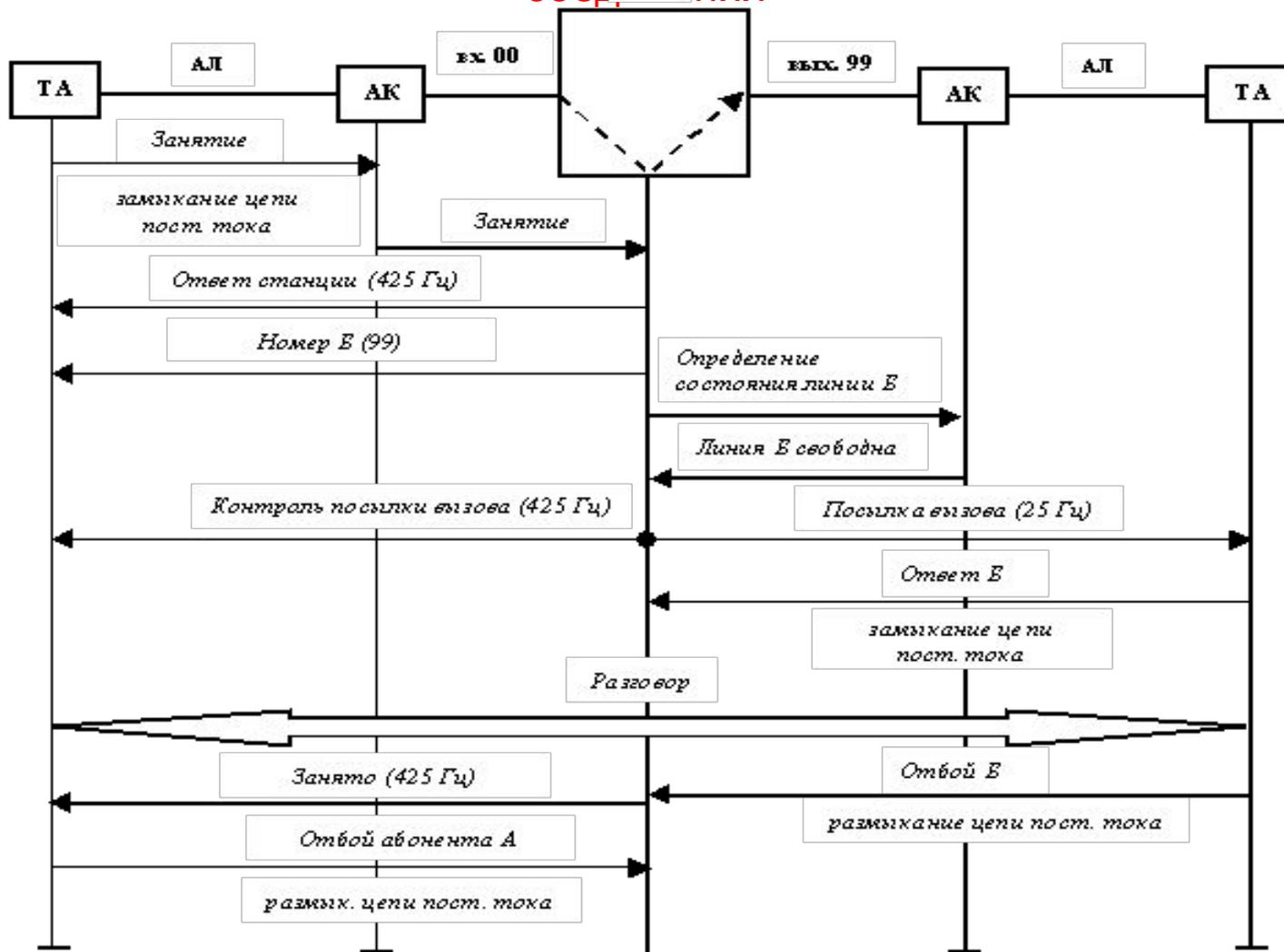
Диаграмма последовательности установления внутривыделенного соединения
