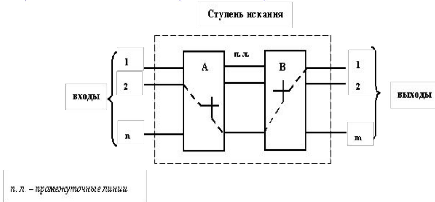
Принято обозначать звенья коммутационной схемы буквами английского алфавита: А, В, С, D и т.д. Многозвенные схемы используются для увеличения доступности. В данных коммутационных схемах применяется принцип **обусловленного** **искания**: выбирается такой выход, к которому есть свободная промежуточная линия, доступная входу.
