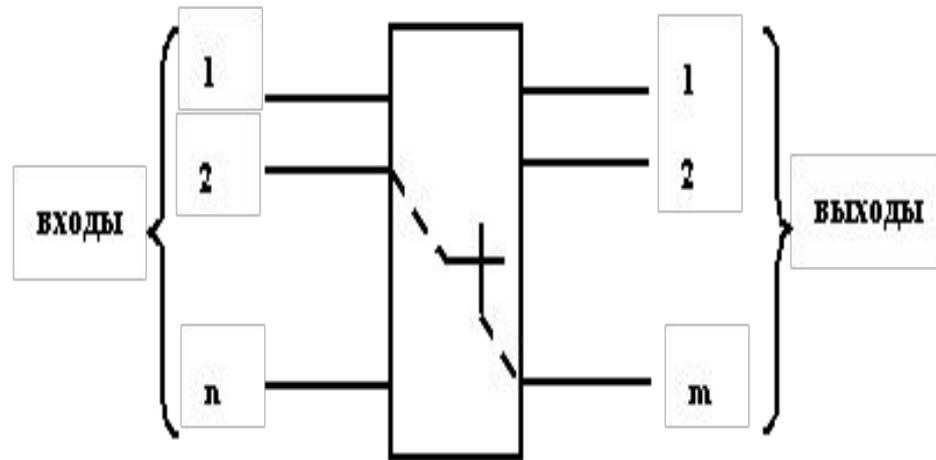
используются для увеличения доступности. В данных коммутационных схемах применяется принцип **обусловленного** **искания**: выбирается такой выход, к которому есть свободная промежуточная линия, доступная входу.
