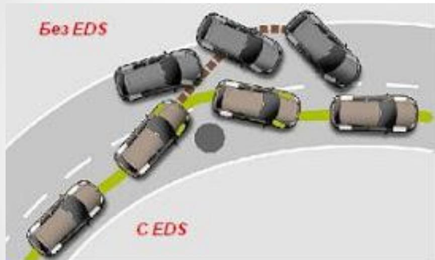
Система управления курсовой устойчивостью автомобиля (ESP — от англ. Electronic Stability Program) представляет собой систему с обратной связью, которая позволяет сохранить курсовую устойчивость во время движения автомобиля. Она объединена с тормозной системой и силовой передачей. В России ее называют противозаносной системой (ПЗС).
