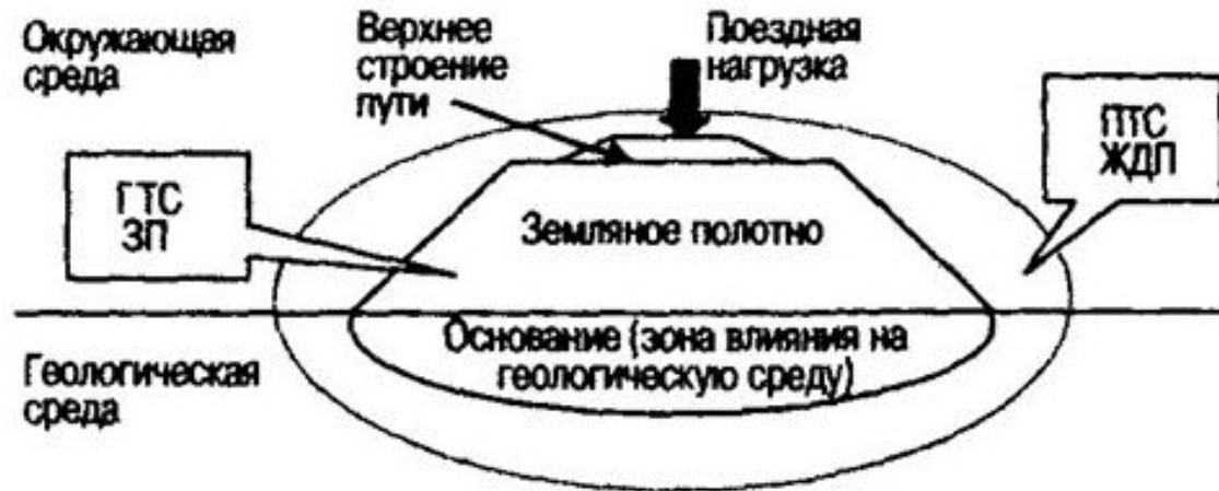
Рис. 3.12. Схема геотехнической системы «Земляное полотно» железных дорог
