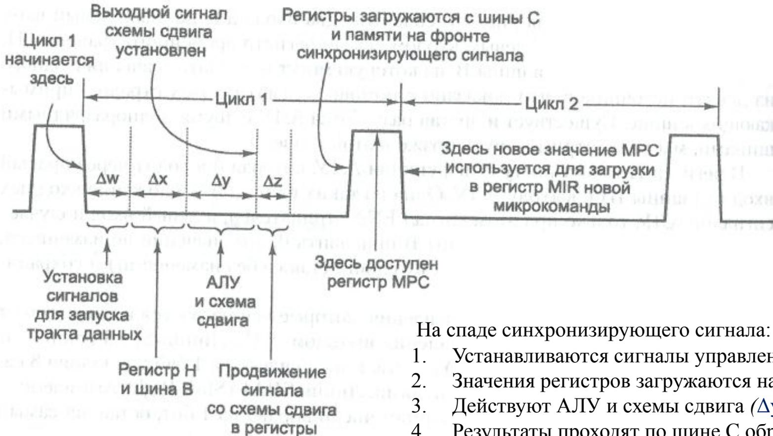
На спаде синхронизирующего сигнала:
