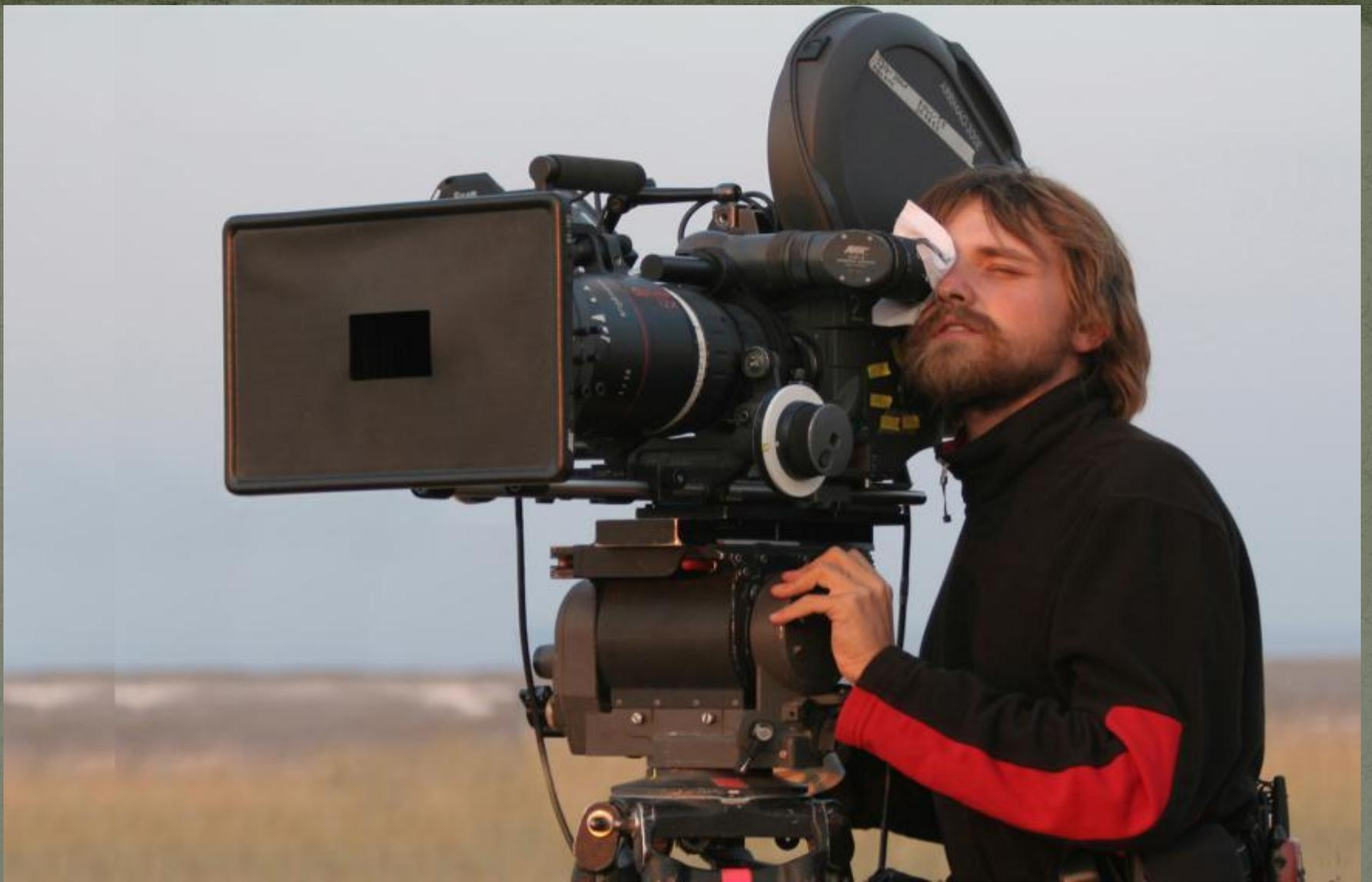
Это - кинокамера. Кинокамера много раз в секунду фотографирует всё, что находится перед ней. Человек, управляющий кинокамерой, называется оператором. Получается, что оператор снимает фильм кинокамерой на специальную плёнку.
