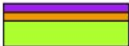
(b) нанесение фоторезиста
