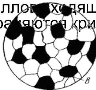
Рис. 4.1. Схема микроструктуры механической смеси
