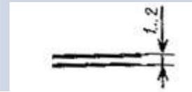
8. Линия механической связи со ступенчатым движением
