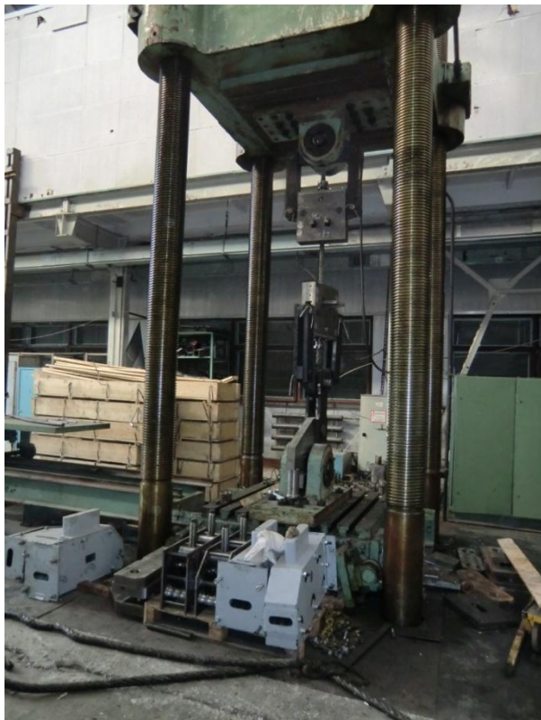
Машина для растяжения образцов с нагрузкой 2500 тонн.
