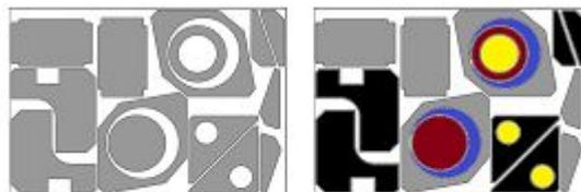
Пример раскроя деталей, содержащих внутренние контуры и группы для мультиконтурной резки
