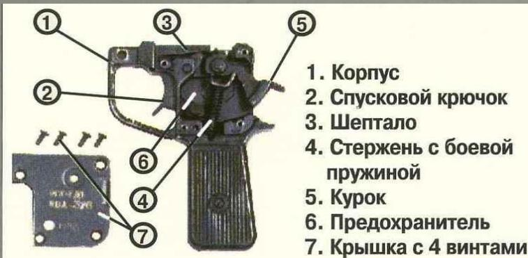
Ударно-спусковой механизм служит для постановки гранатомета на боевой взвод, спуска курка с боевого взвода и нанесения удара по бойку.
