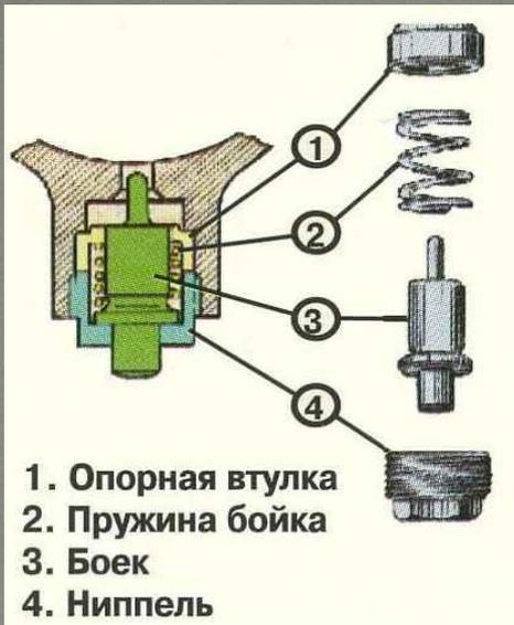
**БОЙКОВЫЙ МЕХАНИЗМ** служит для разбивания капсюля воспламенителя гранаты, он помещается в гнезде основания бойкового механизма и состоит из бойка, пружины бойка, опорной втулки и ниппеля.
