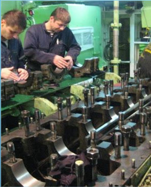
Средний ремонт осуществляет ремонтные предприятия для восстановления эксплуатационных характеристик дизеля до очередного среднего или капитального ремонта. При среднем ремонте разбирают дизель, дефектуют, ремонтируют или частично заменяют детали цилиндропоршневой группы и подшипники коленчатого вала, затем собирают и регулируют дизель.
