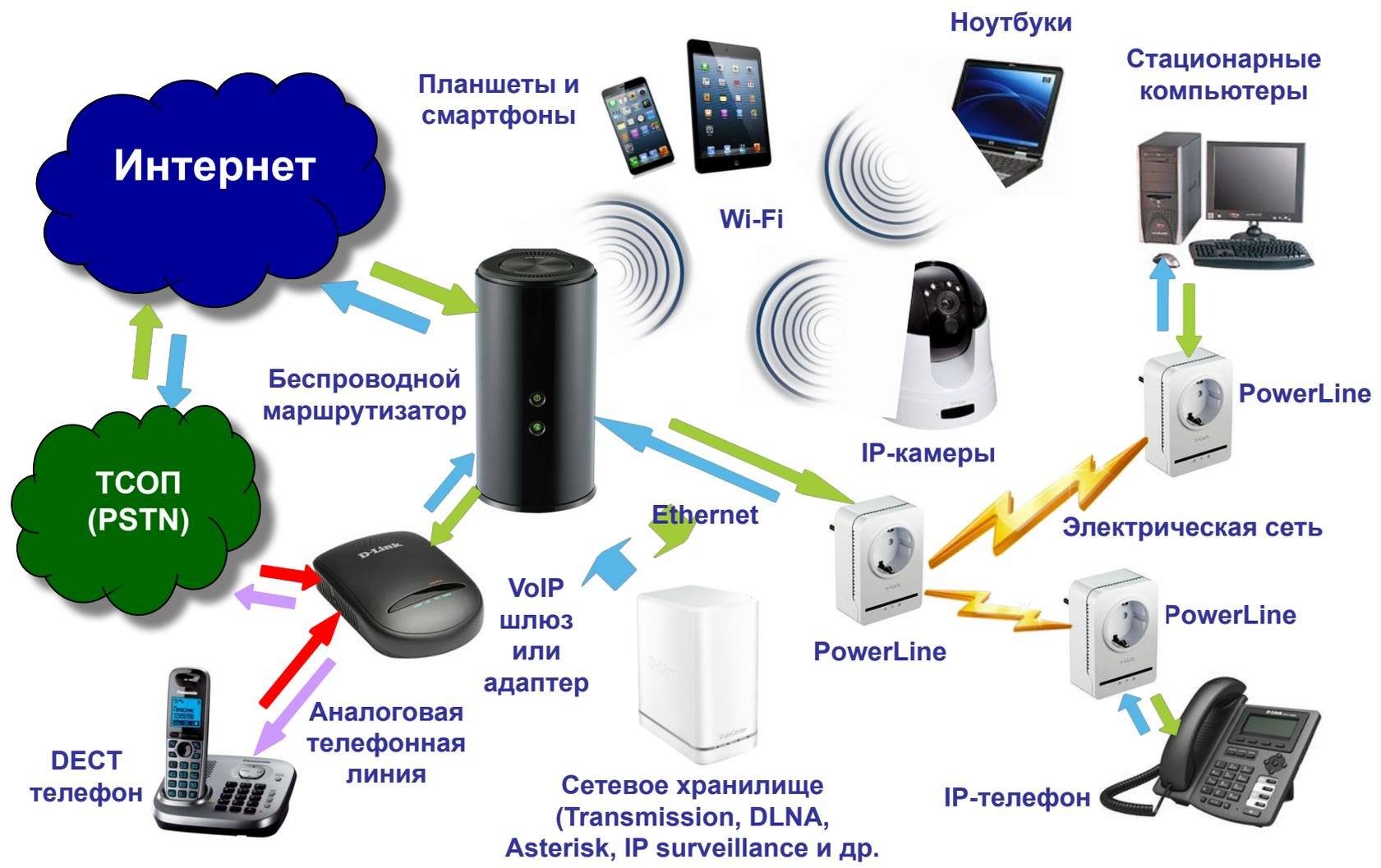
Типовая современная домашняя сеть на оборудовании D-Link
