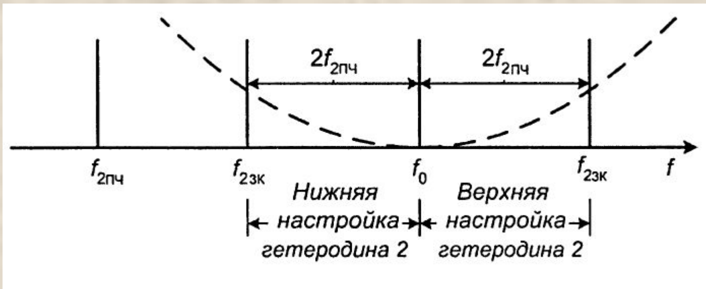
Рисунок 4 – Расположение помехи по второму зеркальному каналу в тракте принимаемой частоты при верхней и нижней настройках гетеродина
