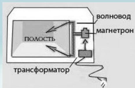
Источником излучения является высоковольтный вакуумный прибор — магнетрон. На нить накала магнетрона необходимо подавать высокое напряжение - около 3–4 кВ. Сетевое напряжение питания (220 В) магнетрону недостаточно, и питается он через специальный высоковольтный трансформатор. Для охлаждения магнетрона рядом с ним имеется вентилятор.
