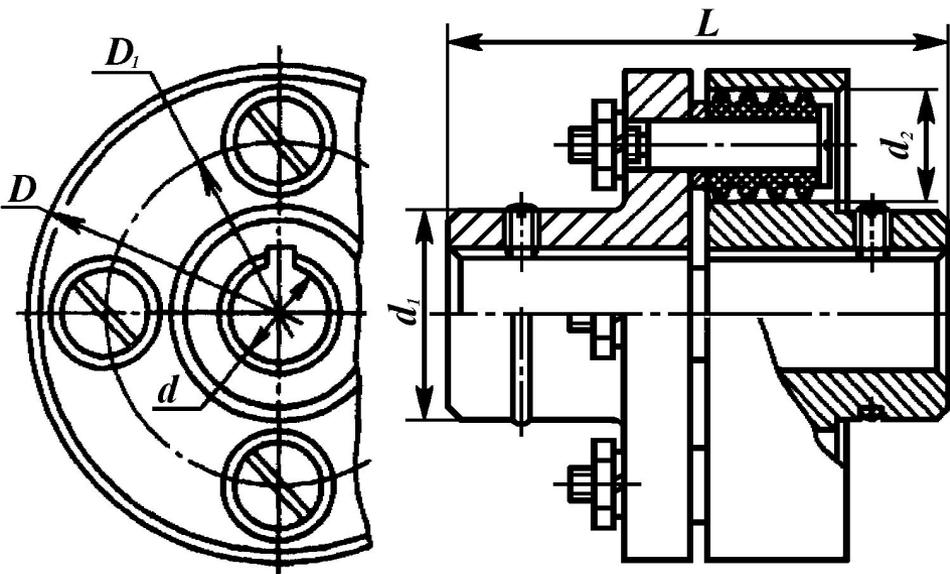
Рис. 16.10. Муфта упругая втулочно-пальцевая
