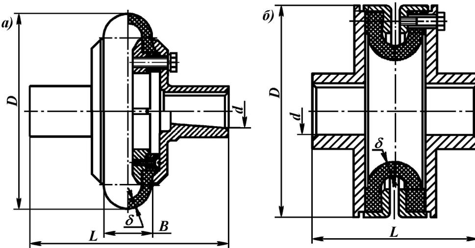
Рис. 16.11. Муфта с неразрезной торообразной оболочкой:
