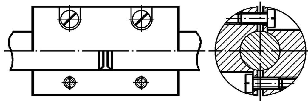
**Рис. 16.2. Муфта продольно-разъёмная**
