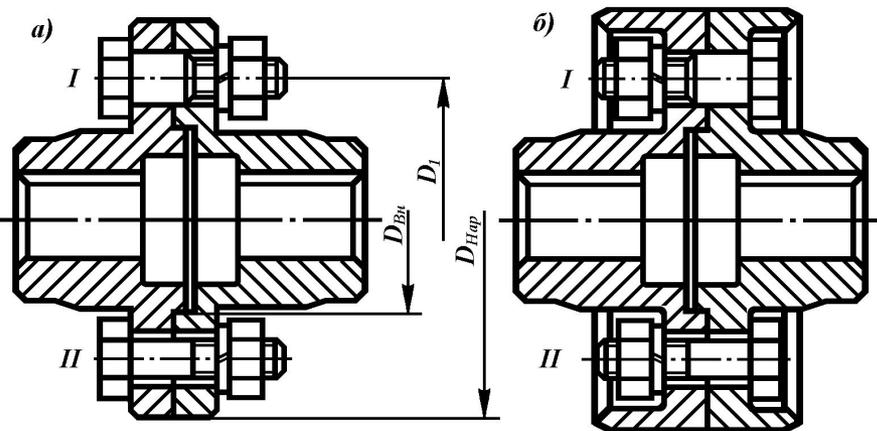
**Рис. 16.3. Муфта фланцевая:**
