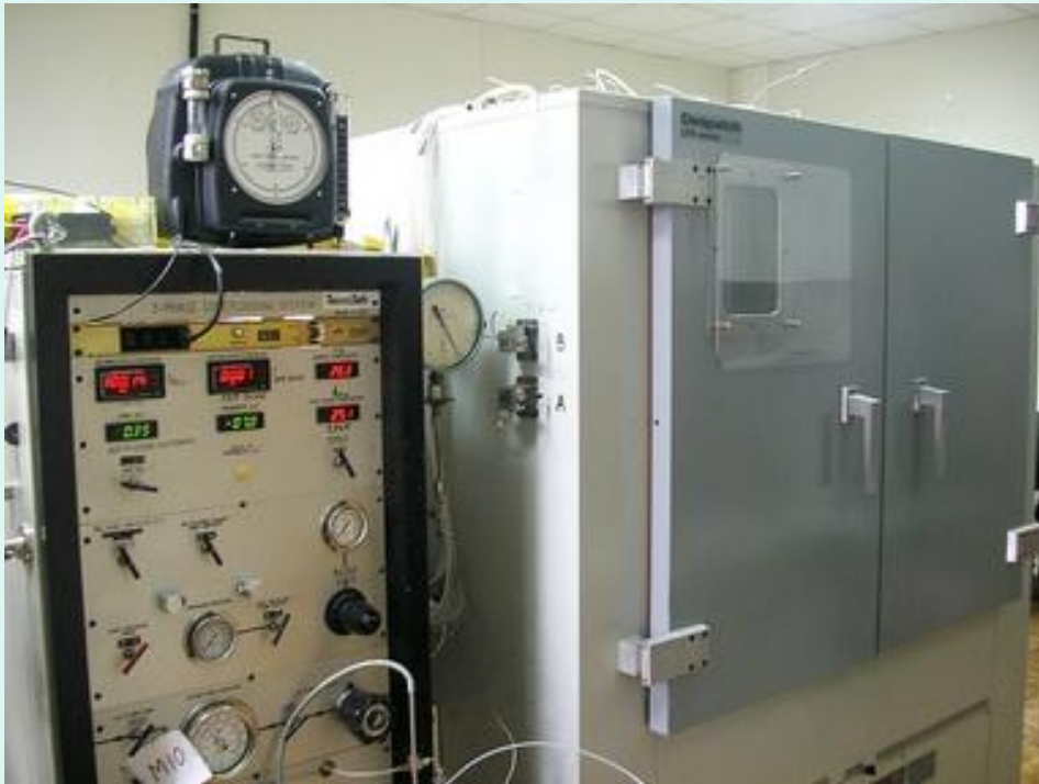
Кабинет управления/контроля и термошкаф с системой насосов, 3-х фазным УЗ-сепаратором и аккумуляторами флюидов 3-х фазной фильтрационной установки
