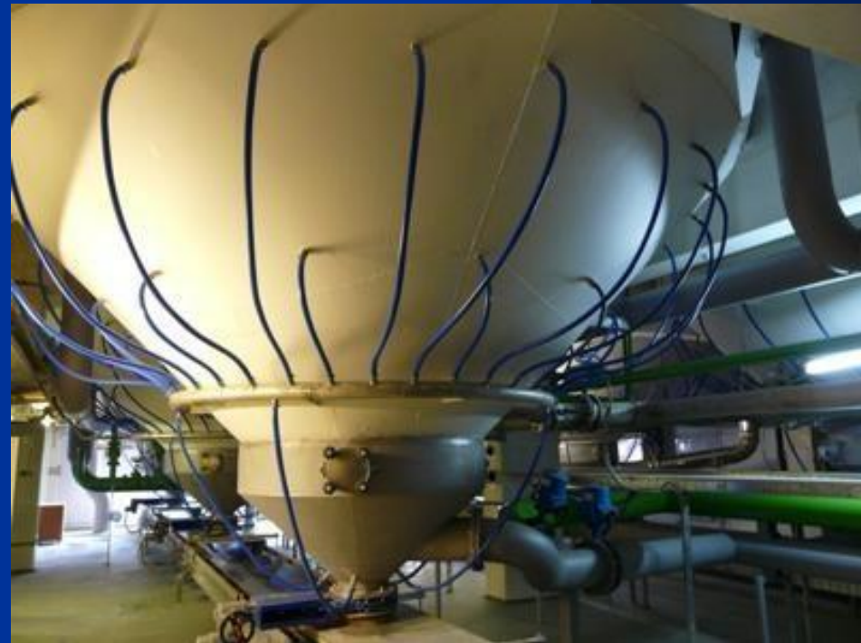
Подача воздуха в замочный аппарат через систему форсунок
