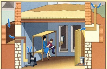
Подвал одноэтажного здания, приспособленный под противорадиационное укрытие
