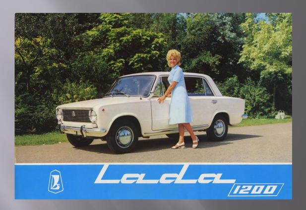
За основу при выпуске малолитражного с пятиместным кузовом «ВАЗ-2101» был взят «ФИАТ-124». Мощность четырехцилиндрового двигателя составляла 60 л. с., максимальная скорость — 140 км/ч. «Жигули» задумывались как народный автомобиль, который при сравнительно невысокой цене мог бы насытить «ненасытный» советский рынок. Но конструкторы и заводские инженеры и механики в дальнейшем столкнулись с массой проблем, которые помешали эффективно решать поставленные задачи.
