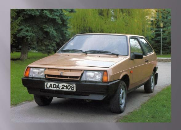
■ Новым словом в машиностроении стала ВАЗ-2108. Её производство началось в 1984 году. Это был первый советский серийный автомобиль, оснащавшийся передним приводом. Как и внутреннее строение автомобиля сильно отличался и внешний вид. Автомобиль получил первый в своём роде кузов "Трёхдверный хэтчбэк". Машина оснащалась двигателями пяти типов, широко различавшихся в показателях. С этим автомобилем Завод получил новое направление в машиностроении.
