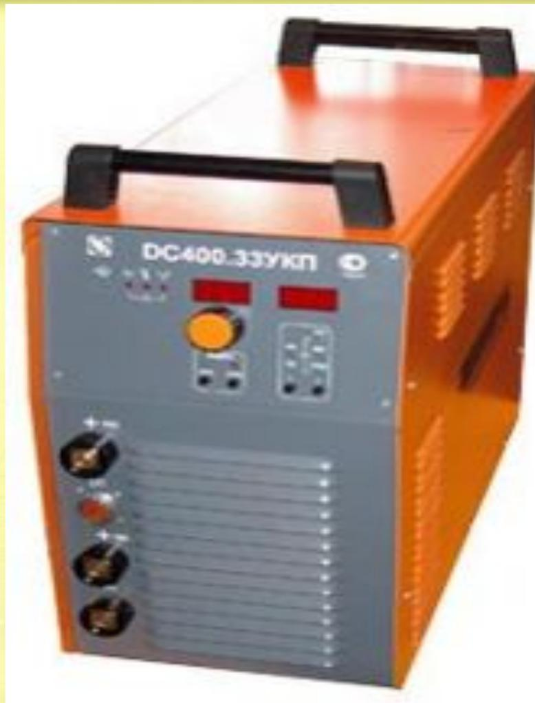
**Для обеспечения качественного проплавления притупления при наложении подварочного шва, а также исключения прожогов и вытекания расплавленного металла с обратной стороны шва, воспользуемся инверторным источником питания ДС400.33УКП фирмы «Технотрон» с управляемым каплепереносом.**
