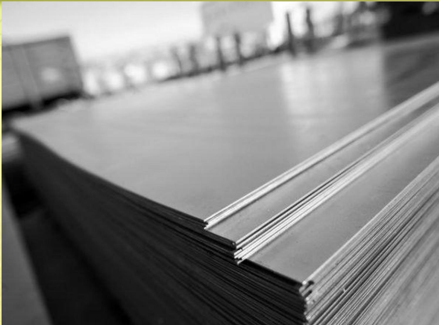
**Конструкция изготавливается из стали 09Г2. Популярность и спрос на сталь 09Г2 обусловлен высокими механическими свойствами при изготовлении металлических элементов строительных конструкций.**
