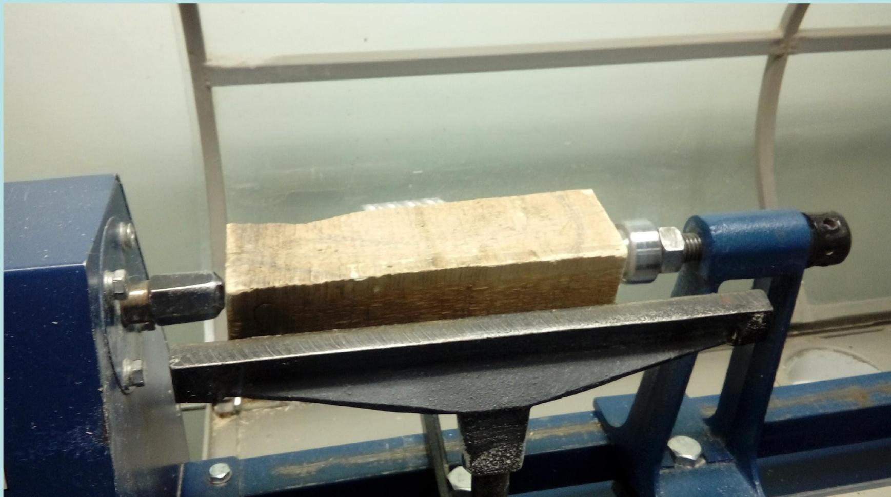
Выполняем черновое точение (от диаметра заготовки зависит размеры будущей поделки)
