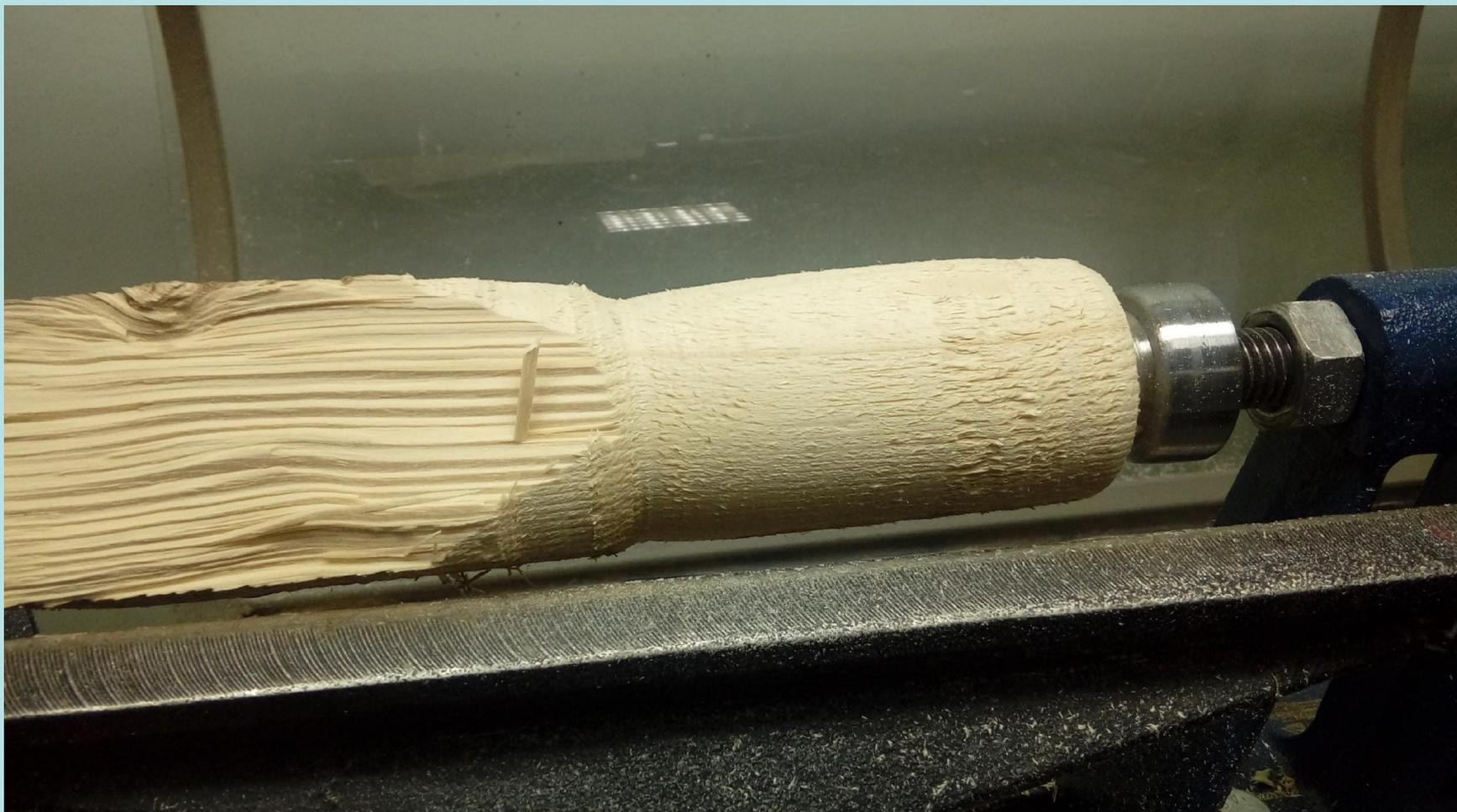
Снимаем заготовку и отмечаем новое место крепления на одном из торцов (на 8-10 мм выше центра заготовки)
