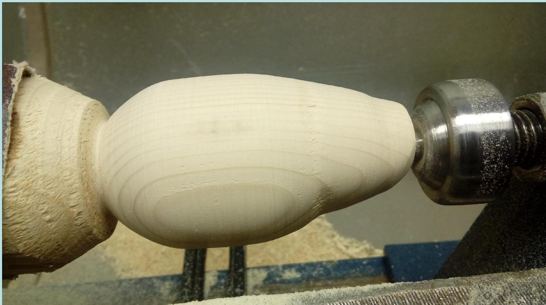
Отпиливаем ножовкой пяточок (под углом) и выточенную деталь от заготовки
