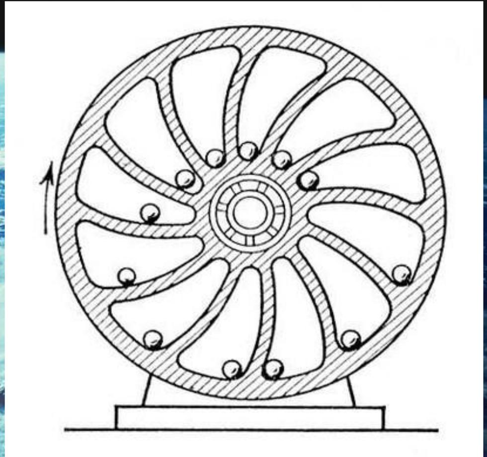
Почему двигатель не работает: Двигатель не будет работать потому, что такие механизмы могут совершать работу лишь за счет первоначального запаса энергии, сообщенного им при пуске; когда же этот запас будет полностью израсходован, вечный двигатель остановится.
