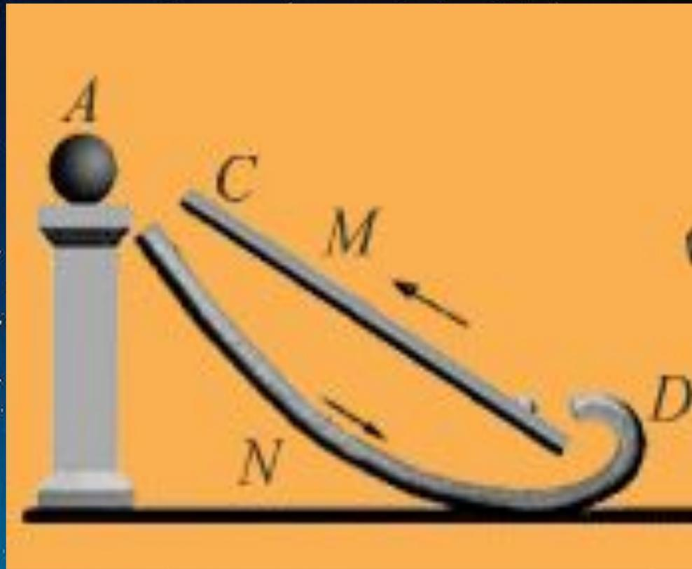
Почему двигатель не работает: Устройство работало бы, если бы магнит действовал на металлический шарик только во время его подъема на подставку по верхнему желобу. Но вниз шарик скатывается замедленно под действием двух сил: тяжести и магнитного притяжения. Поэтому к концу спуска он не приобретёт скорость, необходимую для поднятия по закруглению нижнего желоба и начала нового цикла.
