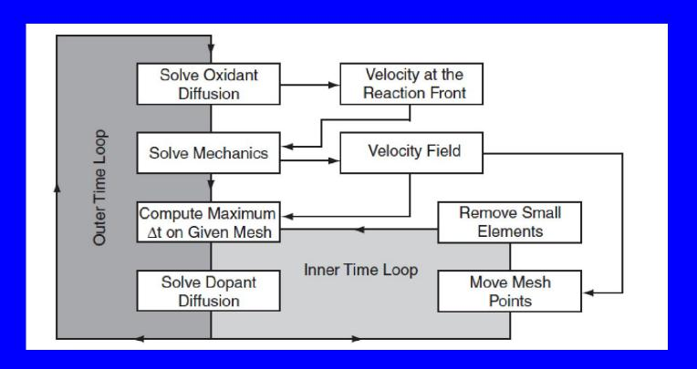
Схема процессов, включающих рост одного материала за счет другого, содержит два цикла: внутренний и внешний
