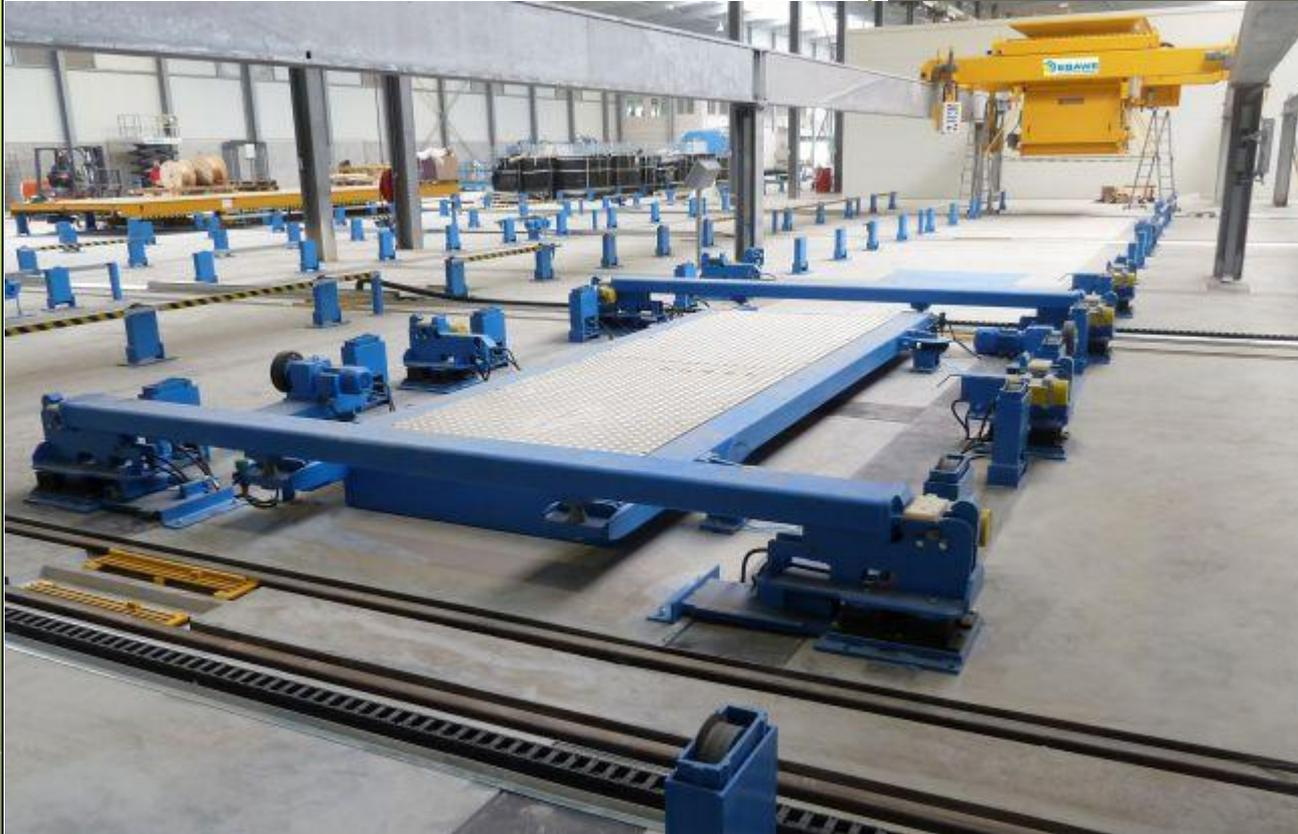
Для обеспечения высокого качества бетона и точного формирования краёв и кромок свежезагруженный бетон необходимо уплотнить. По желанию клиента и в зависимости от конечного продукта могут использоваться уплотняющие установки с движениями в горизонтальном или вертикальном направлениях, или альтернативно, в комбинированном исполнении с движениями как в горизонтальном, так и вертикальном направлениях. При этом частоту колебаний можно плавно изменять в соответствии с различными типам элементов.
