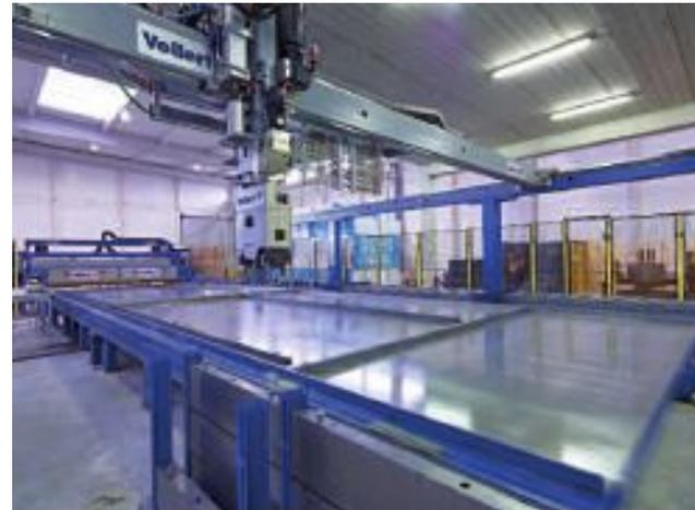
Нанесение контуров и позиционирование опалубочной системы происходит с помощью компьютерных систем управления CAD-CAM
