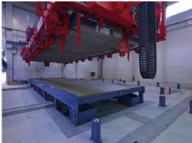
После точного позиционирования над свежабетонированной второй оболочкой, первая оболочка опускается при помощи электрического подъемного устройства
