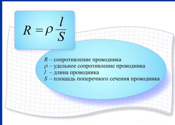
The diagram features a white background with a light blue grid pattern. At the top, a light blue rounded rectangle contains the formula  $R = \rho \frac{l}{S}$ . Below this, a larger light blue oval contains a list of variables:  $R$  – сопротивление проводника,  $\rho$  – удельное сопротивление проводника,  $l$  – длина проводника, and  $S$  – площадь поперечного сечения проводника.
