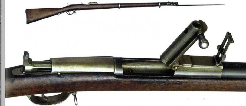
10,67-мм винтовка системы Бердана обр. 1868г. с трехгранным итёмком.
