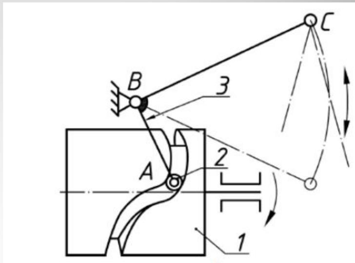
Ведущим звеном этого механизма является цилиндрический кулачок 1. Это позволяет выполнять нужный профиль паза и получать движение глазка С нитепритягивателя, который наиболее соответствует закону необходимой подачи нити. Исходным (ведомым) звеном механизма является коромысловый толкатель 3 с роликом 2 и отростком ВС.
