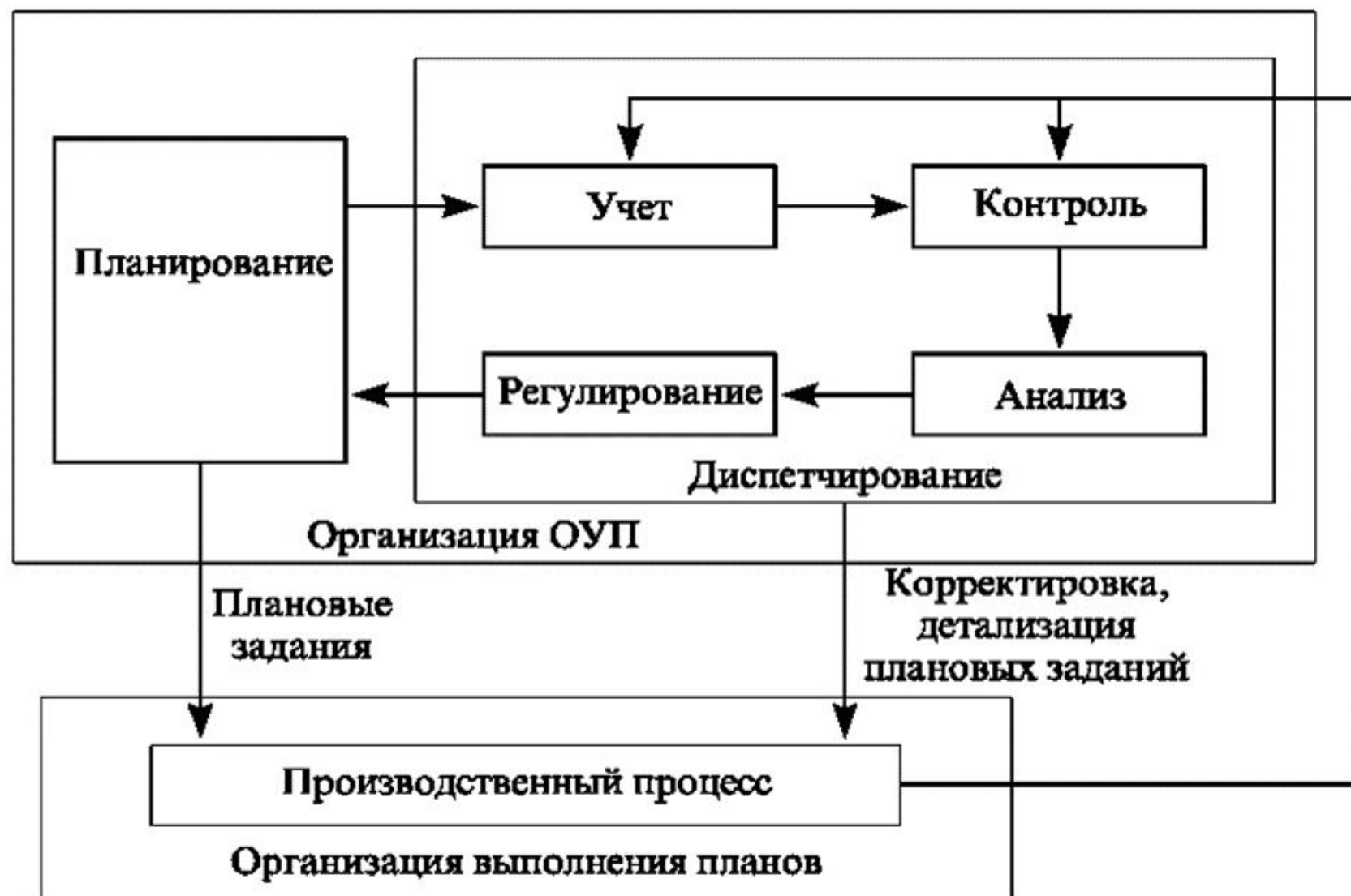
Рис. 28. Схема функциональной структуры системы ОУП
