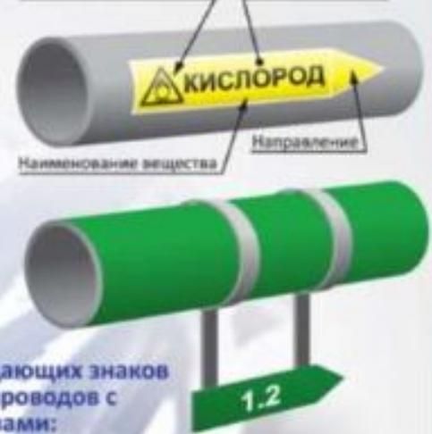
Использование предупреждающих знаков для маркировки трубопроводов с опасными веществами:
