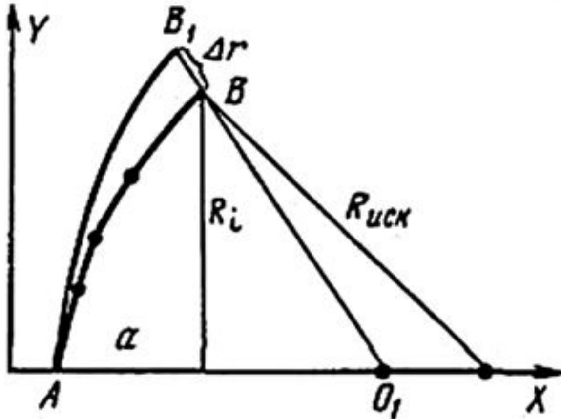
Схематичное изображение аппроксимации контура дугой окружности с учетом допустимой ошибки:
