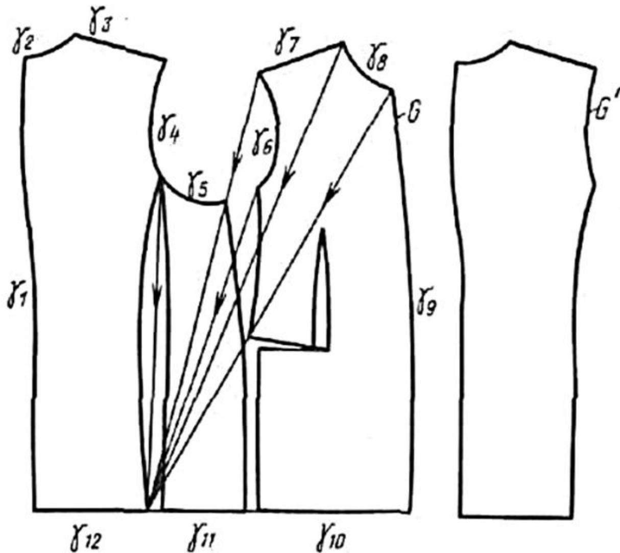
Обобщенный контур развертки изделия и его преобразование с целью выявления отдельной детали
