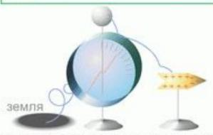
Соединяя заряженное тело с электрометром можно измерять потенциал тела - это разность потенциалов между заряженным телом и Землей
