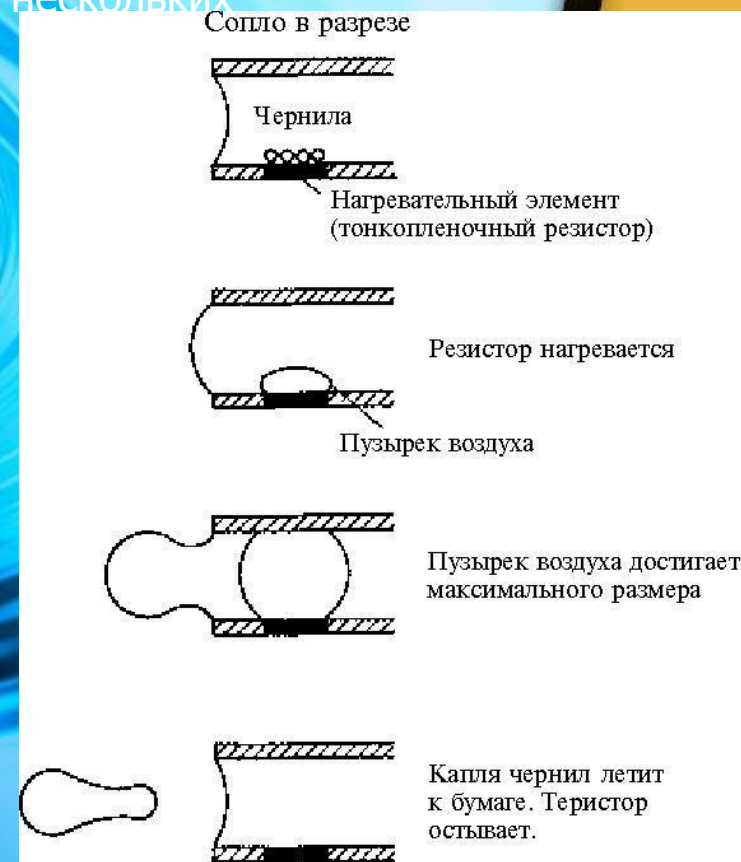
Принцип работы струйного принтера
