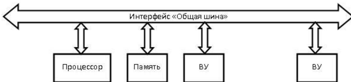
Рис. 1. Структурная схема микропроцессорной системы
