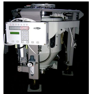
Весы бункерные для статического взвешивания и учета прохождения жидкости (растительное масло), поступающей самотеком непрерывным потоком.
