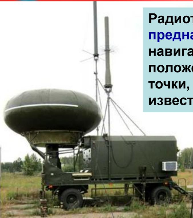
Радиотехническая система ближней навигации РСБН-4Н предназначена для автоматического определения навигационных параметров, характеризующих положение ЛА относительно радионавигационной точки, координаты которой на местности точно известны.
