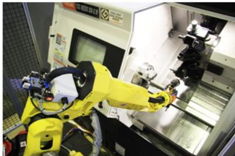
**Гибкие производственные системы (FMS)** - комплексные системы, которые могут включать в себя станки с числовым программным управлением, роботов и автоматизированные системы обработки материалов, то есть это полностью автоматизированные линии для полного цикла производства продукции.
