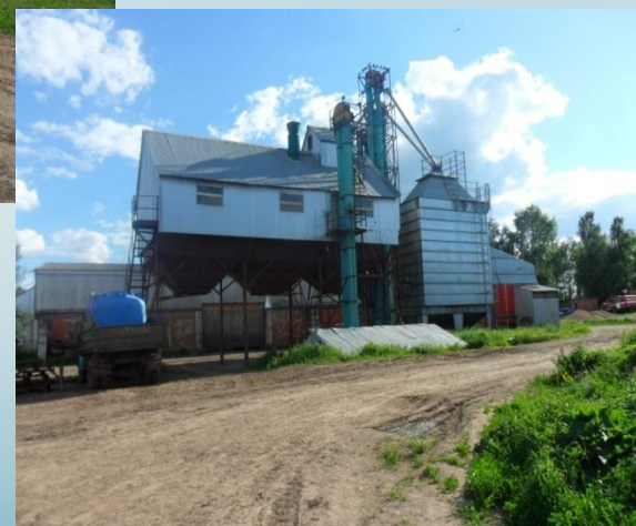
Новый КЗС -20 с пропускной способностью 20 тонн зерна в час.
