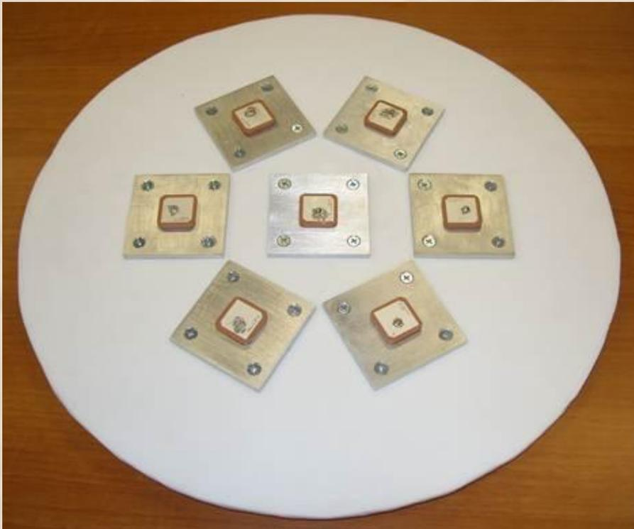
**Семиэлементная антенная решетка для работы в диапазоне частот  $\mathcal{L}1$  на основе керамических микрополосковых элементов.**
